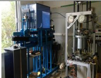
Vue du système de chargement de la cellule triaxiale
