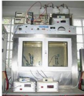
Huit appareillages à états hydrique et température contrôlés
